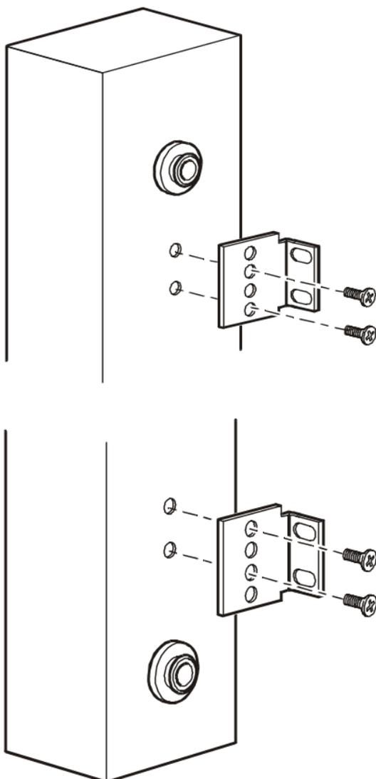
2. Coloque la PDU montada en estante en un riel de montaje vertical del estante o armario con los tornillos y tuercas encajadas suministrados con el armario.
