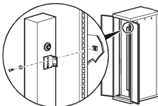
**Montaje horizontal.** Puede instalar la PDU montada en estante en un armario NetShelter de 48,26 cm (19 pulg.) o en cualquier otro estante EIA-310-D estándar de 48,26 cm (19 pulg.):
