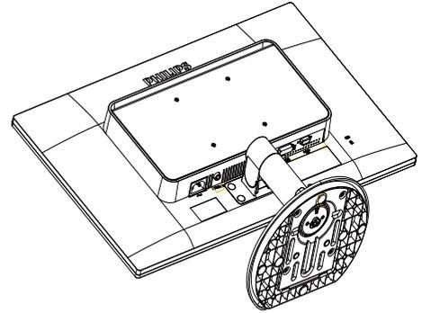
2. Utilice un destornillador plano para quitar los cuatro elementos Mylar de la tapa de la bisagra.
