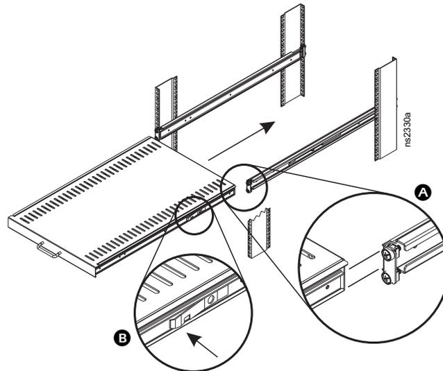
3. Apriete los 8 tornillos del soporte de montaje vertical.
