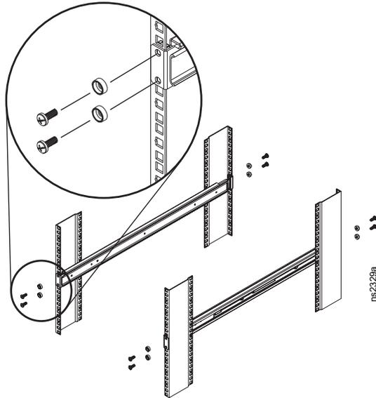
**NOTA:** La longitud de los rieles de la plataforma deslizante debe ajustarse para que coincida con la profundidad del bastidor. Afloje las tuercas de 3/8 pulgadas, si es necesario, para ajustar la longitud.
