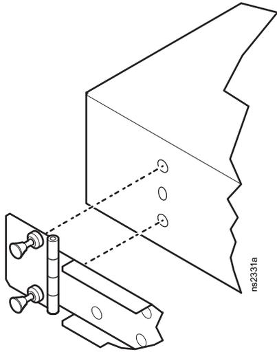
1. Alinee los émbolos del Brazo de Manejo de Cable con los orificios a ambos lados de la parte trasera del Estante Corredizo.
